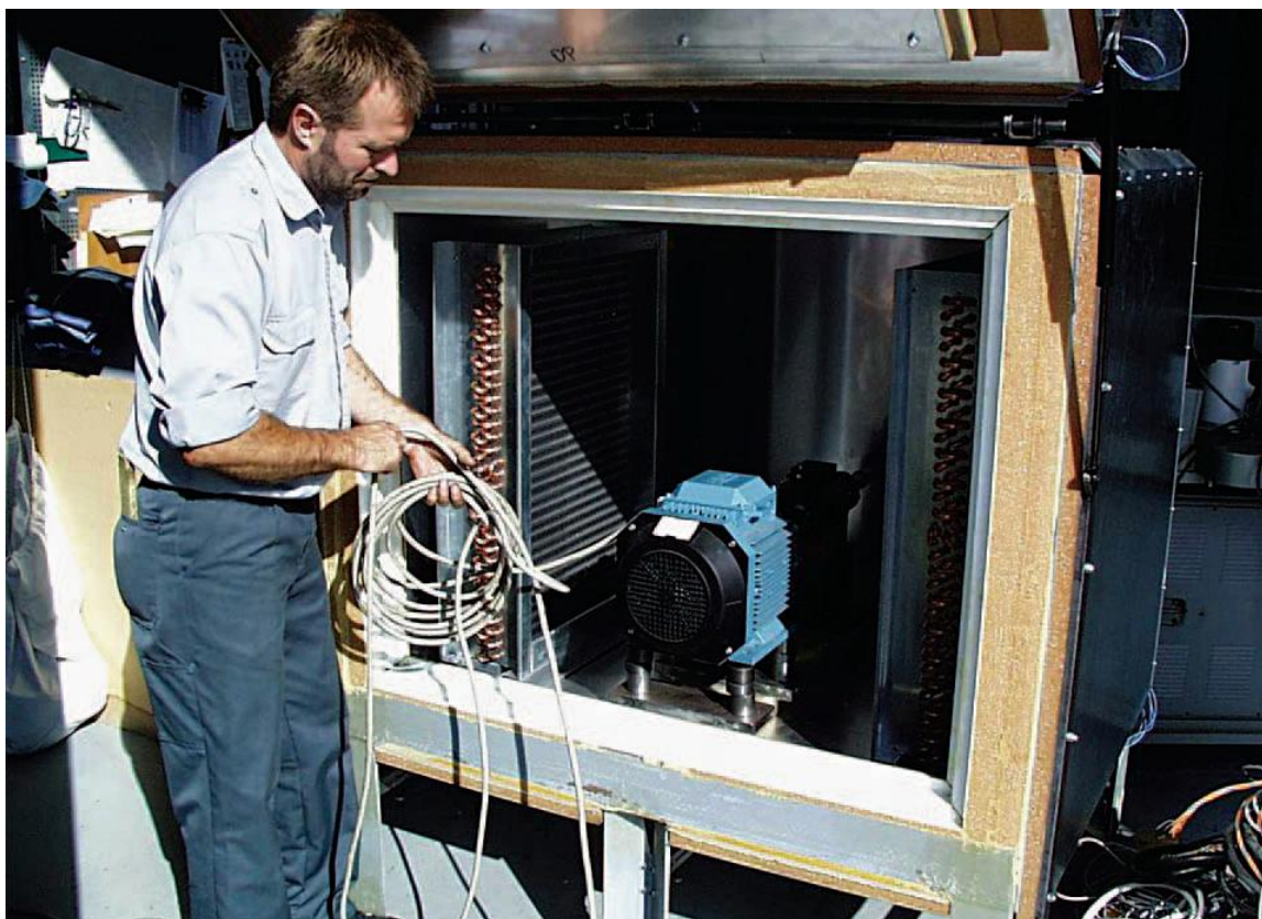
Obr. 1.2 Příklad kalorimetru s uzavřeným okruhem [1]
