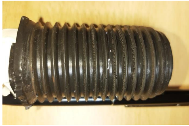
Obr. 2: Replika závitového hnízda (100 % povrchu vnitřního závitu)
