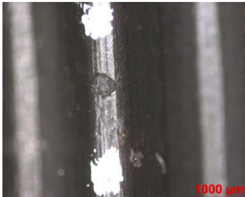
Obr. 4: Detail korozního důlku
