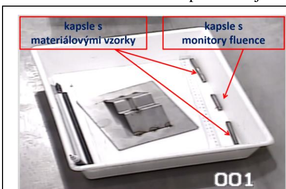
Obr. 6: Kapsle s materiálovými vzorky a monitory fluence
