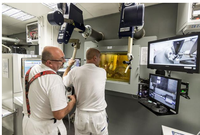
Obr. 6: Dálková manipulace se vzorky uvnitř horké komory
