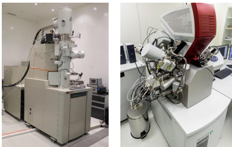
Obr. 9: Mikroskopy HR-STEM (vlevo), FEG-SEM (vpravo)
