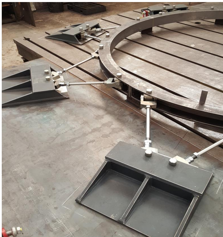
Obr. 2: Kontrolní montáž z odolnění kompenzátoru objemu
