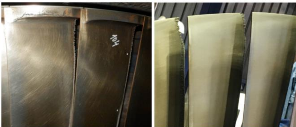
Obr. 3: Erodivané lopatky z elektrárny spalující odpady – servis Doosan Škoda Power
