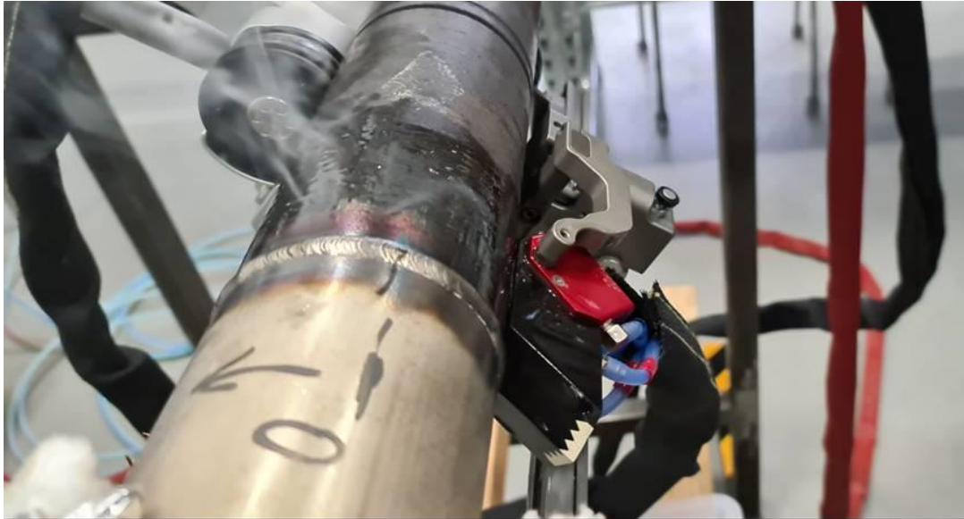
Obr. 2: Zařízení pro vysokoteplotní PAUT s vysokoteplotním manipulátorem
