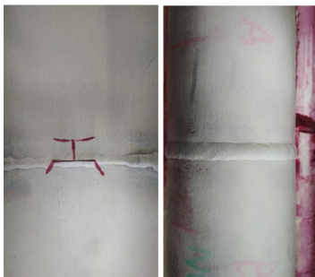
Obr. 3: Výsledky z měření metodou NEWS tělesa z austenitické oceli
