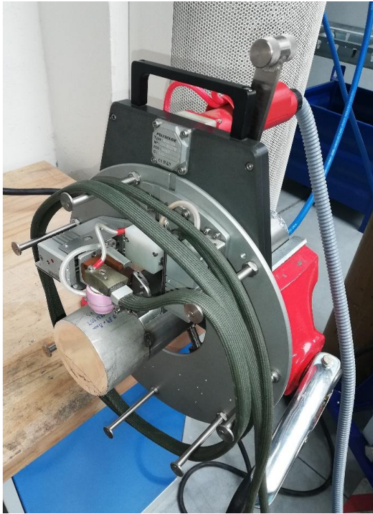
Obr. 2: Příprava orbitální svařovací hlavy
