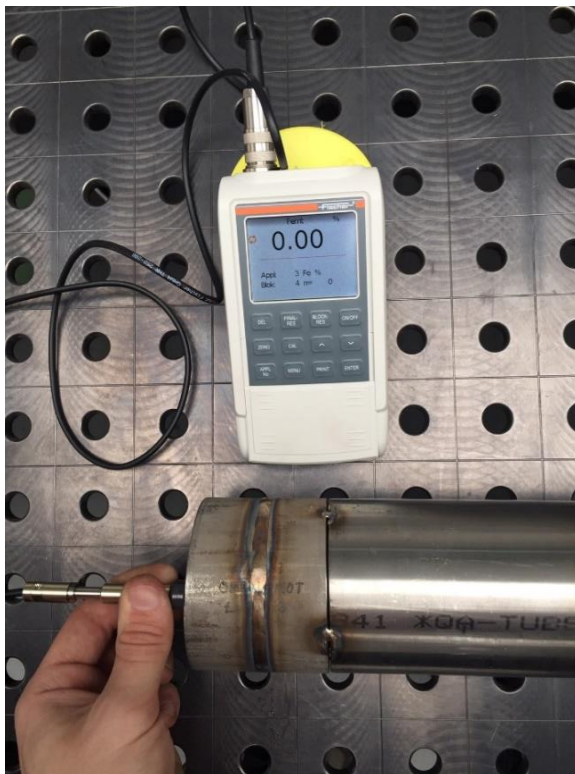
Obr. 4: Stanovení obsahu delta feritu pomocí feritometru na čele trubky po přetavení základního materiálu
