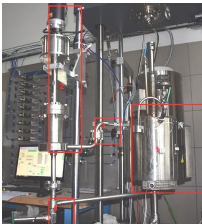
Obr. 2: Zkušební HLM komora s cirkulační smyčkou pro tekutý kov. 1 – zkušební komora, 2 – čerpadlo, 3 – pouzdro pro Mg-pásku, 4 – HLM výpusť.
