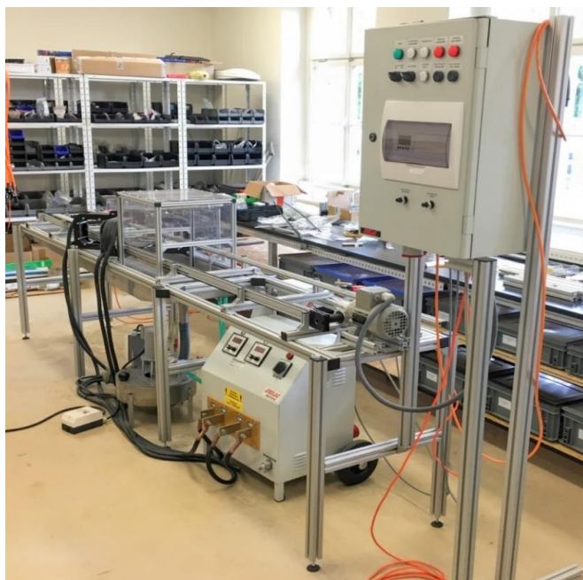
Obr. 1: Celkový pohled na zařízení pro kontrolu výrobků z feromagnetických materiálů
