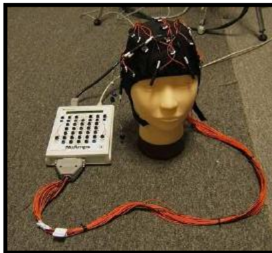
Obrázek 2.4 - Elektroencefalograf a jeho komponenty (EEG čepička a výkonová jednotka) 6
