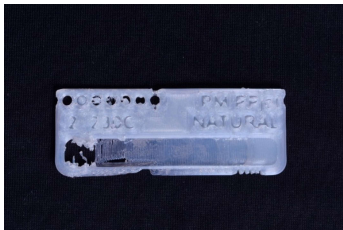
Obrázek 23: PP – testovací destička (Zdroj: Vlastní)
