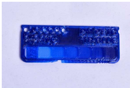
Obrázek 15: PETG – testovací destička (Zdroj: Vlastní)
