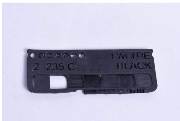
Obrázek 21: TPE - testovací destička (Zdroj: Vlastní)
