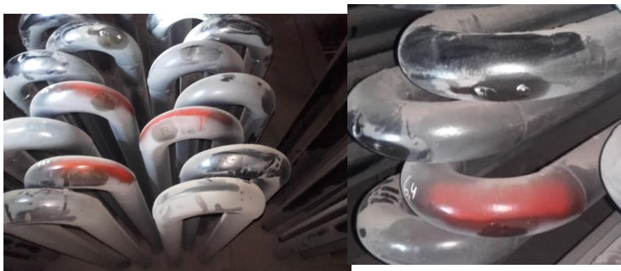
Obr. 2 Erozní opotřebení ložových hadů.
