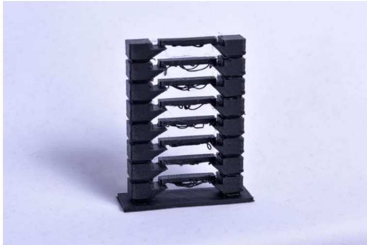
Obrázek 20: TPE – teplotní věž (Zdroj: Vlastní)
