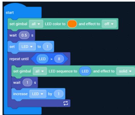
Obr. 7 MOŽNÉ ŘEŠENÍ POSTUPNÉHO ROZSVÍCENÍ LED DIOD (ZDROJ: VLASTNÍ)
