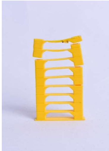
Obrázek 16: ABS – teplotní věž (Zdroj: Vlastní)
