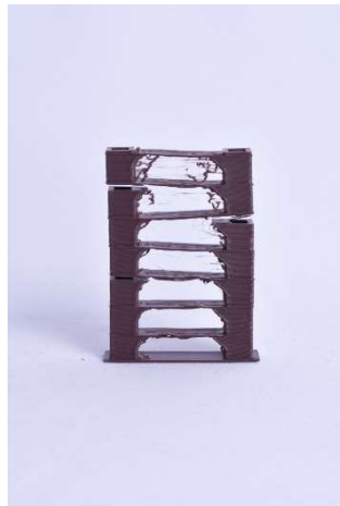
Obrázek 18: ASA - teplotní věž (Zdroj: Vlastní)
