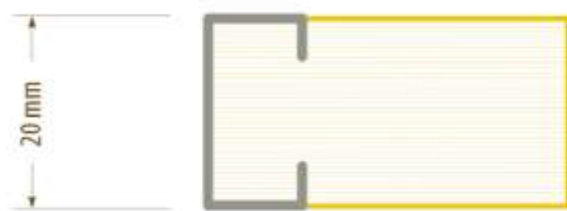
Obr. 15: Jednovrstvá šalovací deska o výšce 20 mm s profilem
