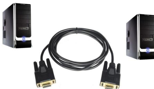
Obr. 1.3 Propojení hostujícího a cílového PC sériovým Laplink kabelem
