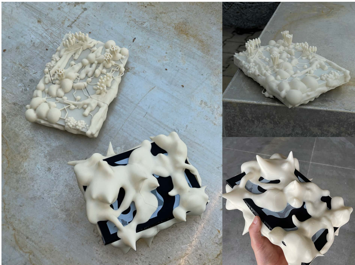
fig. 19 3D tisk obálky na knihu z PLA plastu
