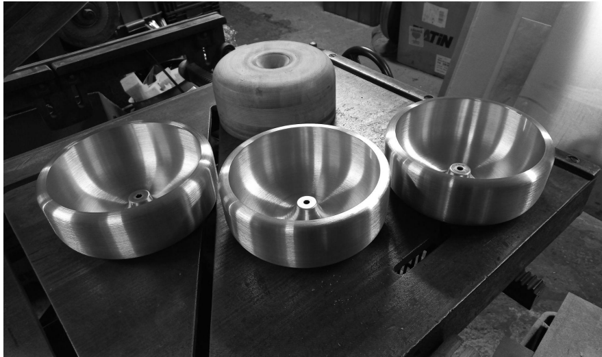
Obr. 21, vyrobené květináče za pomoci technologie kovotlačitelství (archiv autora)
