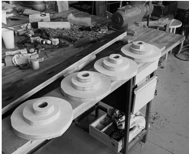
Obr. 22, výroba vyztužení a rozšíření pro dřevěné nohy (archiv autora)
