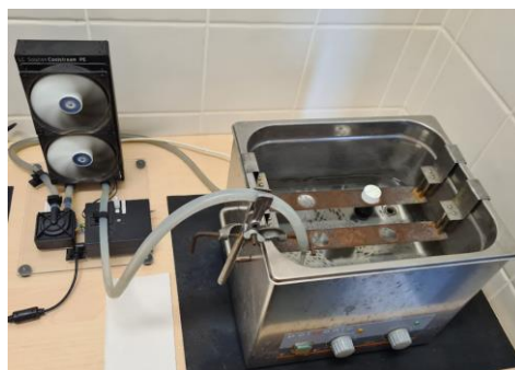
Obr. 25 Sestava pro sonifikaci vzorků
