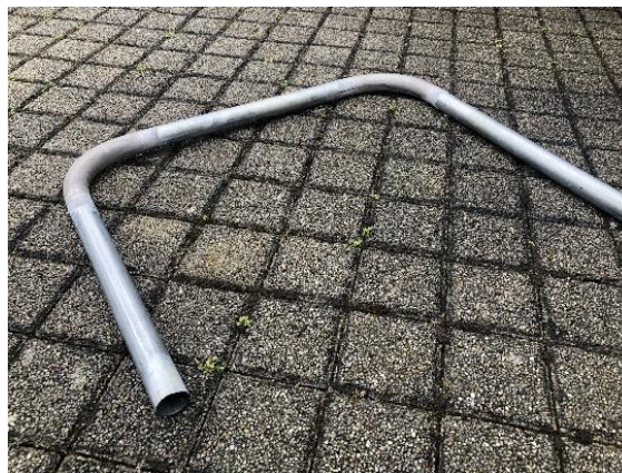
Obr. 31 – Výroba- ohnutí trubky (archiv autora)
