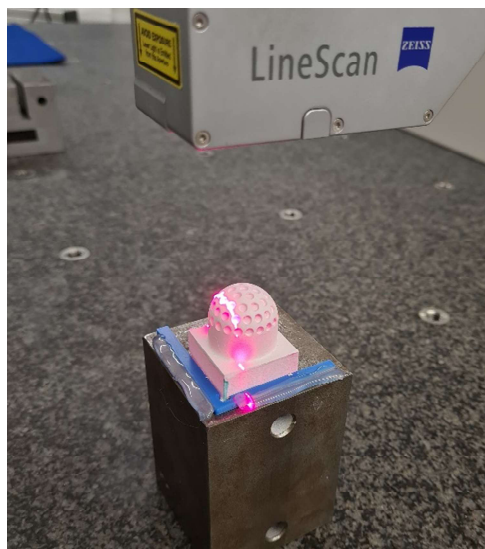
Obrázek 33 - skenování dílu s zmatňující vrstvou
