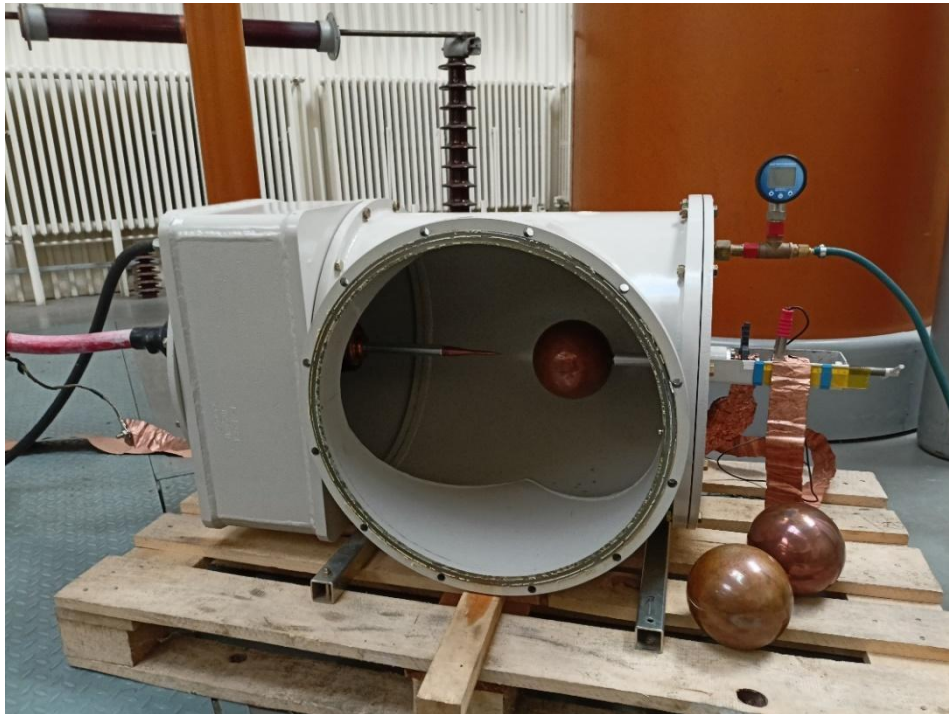
Obr. 3.1 Otevřená tlaková nádoba s testovacími elektrodami
