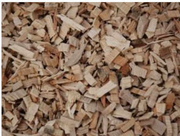
Obr. 13. Dřevní štěpka vyrobená nožovým štěpkovačem
