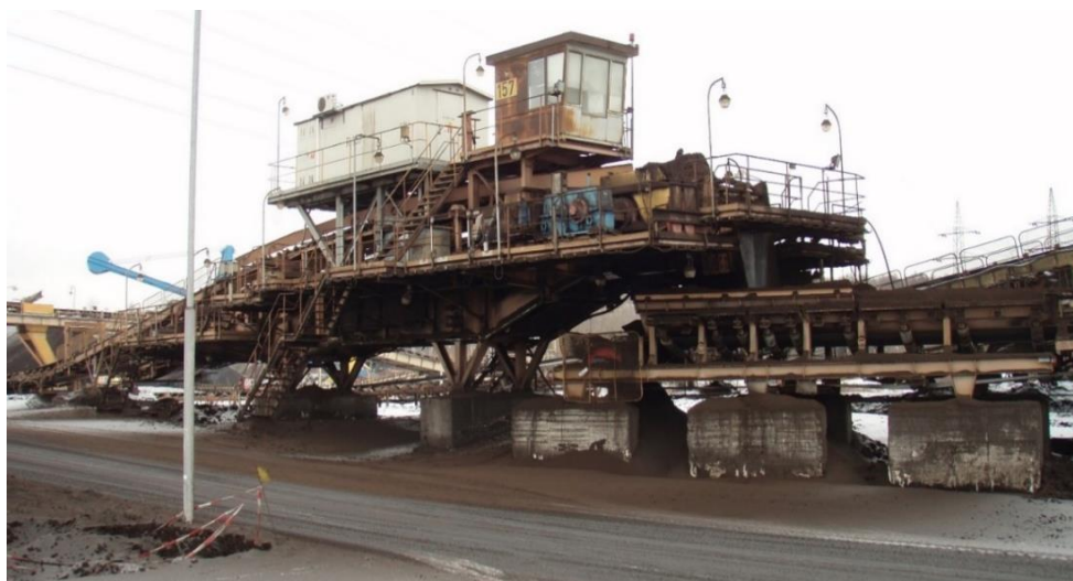
Obr. 2: Příklad dvoububnové hnací stanice s jedním poháněným bubnem
