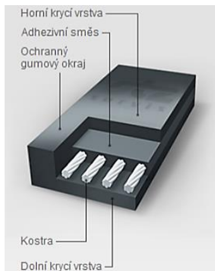
Obr. 20: Řez pryžovým pásem s ocelolanovou kostrou [13]
