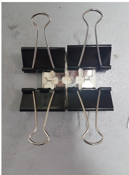
Obr. 36 Poniklované vzorky připravené k pájení
