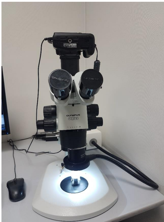
Obr. 38 Optický binokulární mikroskop s připojeným fotoaparátom
