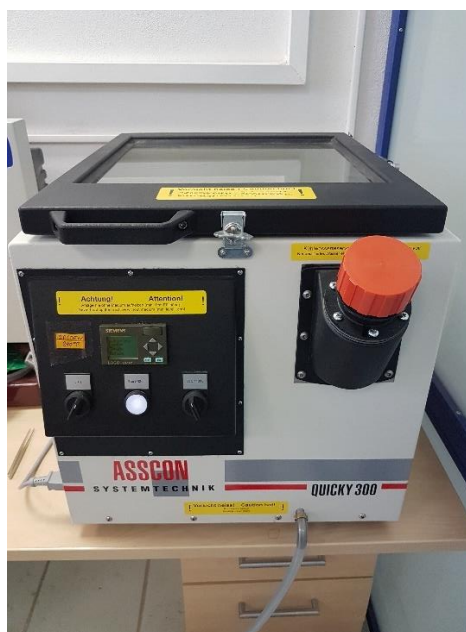
Obr. 37 Systém pro pájení v páře Asscon systemtechnik Quicky 300
