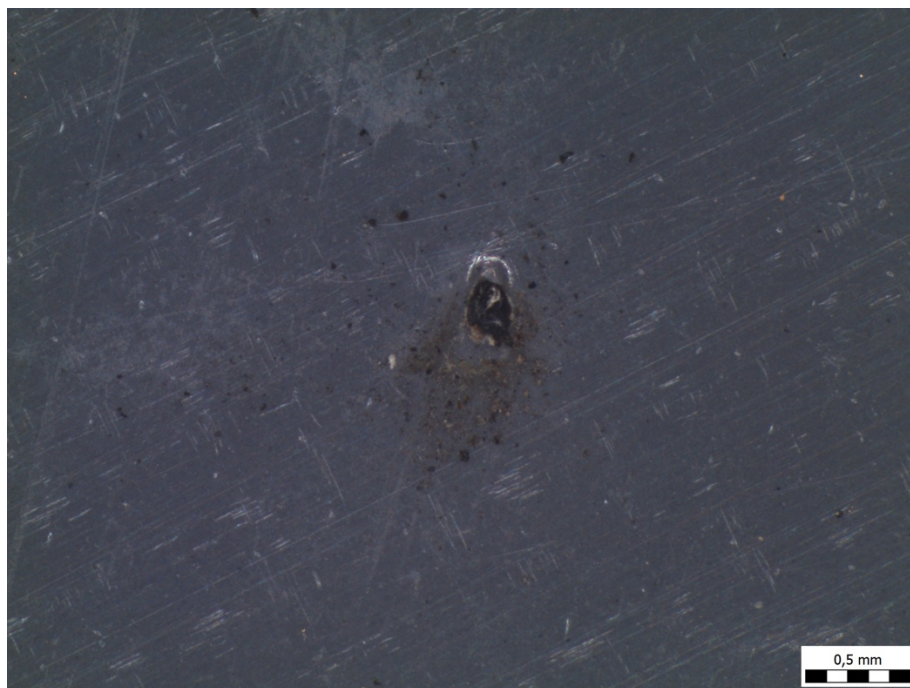
Obr. 20: Fotografie místa průrazu, pořízená mikroskopem
