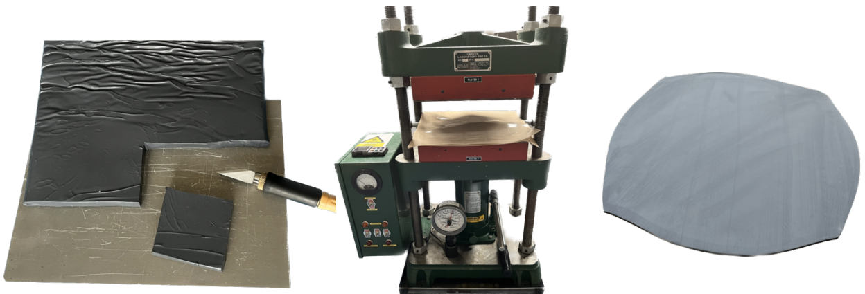
Obr. 3: Výchozí silikonový materiál Bluesil (vlevo), vyhřívaný hydraulický lis (uprostřed) a vzorek připravený lisováním (vpravo)
