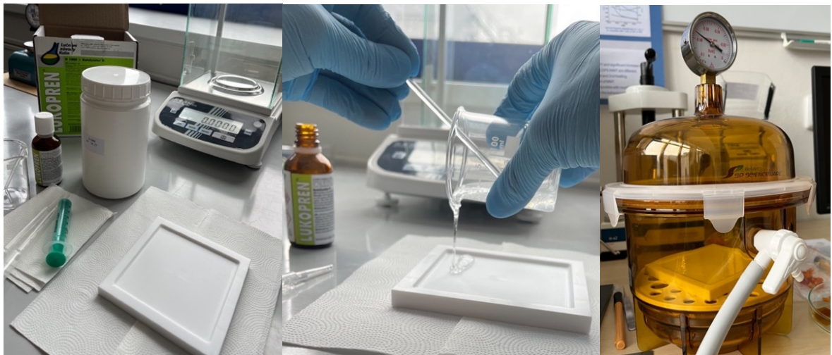
Obr. 4: Příprava dvousložkového silikonu
