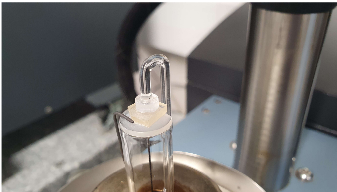
Obr. 25 Pohled na expanzní sondu při měření TMA epoxidu
