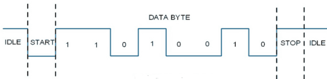
Obr. 2.3 Struktura rámce sériového přenosu UART[16]
