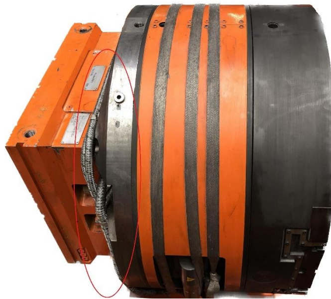
Obr. 99: Elektroinstalace u hlavy d'Andrea UT 8-800 S
