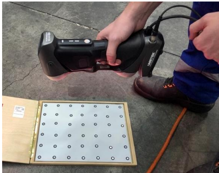
Obr. 45: Kalibrace měřicího přístroje HandyScan 700
