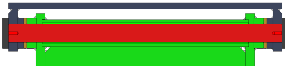
Obr. 22: Uložení horního ramena v horním rámu stolu [5]
