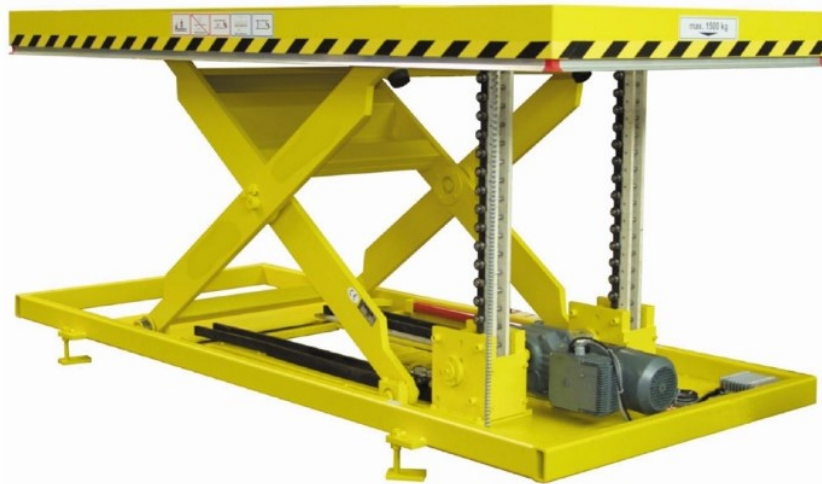
Obr. 17: Nůžkový mechanismus poháněný dvojicí tlačných řetězů [24]
