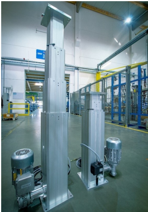
Obr. 20: Teleskopický sloup Phoenix výrobce Columbus McKinnon Engineered Products GmbH [28]
