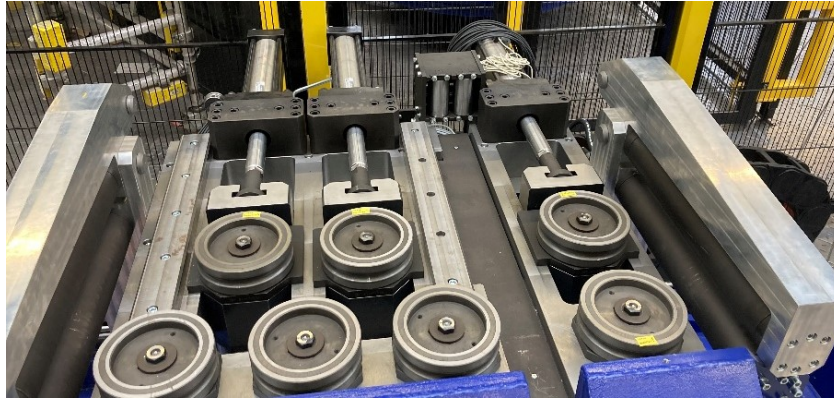
Obr. 3: Soustava rolen na rovnačce (5)
