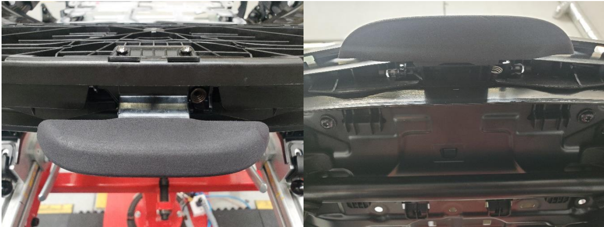
Obrázek 67: Detail uchycení rukojeti z PA 12
