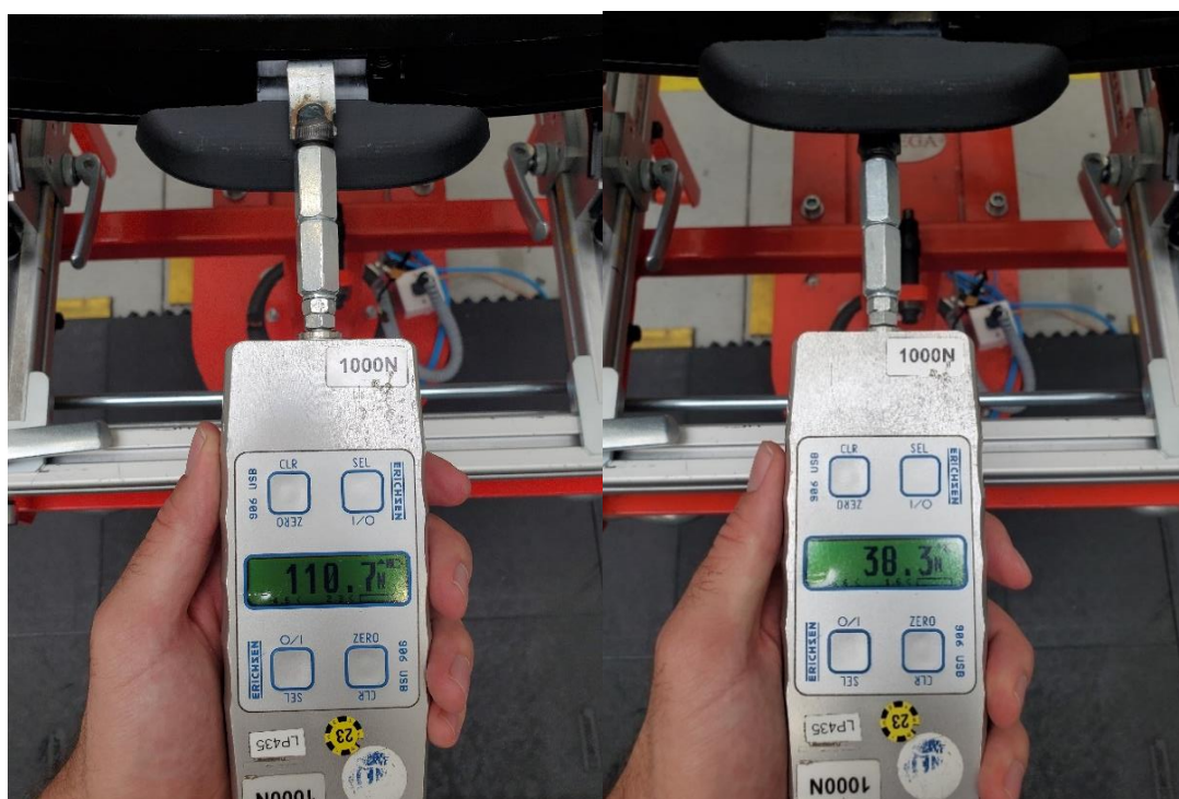
Obrázek 64: Měření max. síly pro uvolnění vzorku rukojeti z ABS
