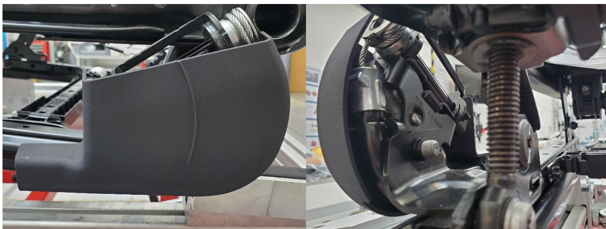
Obrázek 53: Upevněný kryt PLP cover z materiálu PA 12
