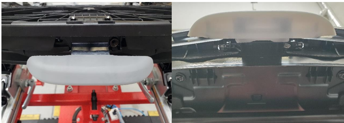
Obrázek 65: Detail uchycení rukojeti z Tough 1500 resin
