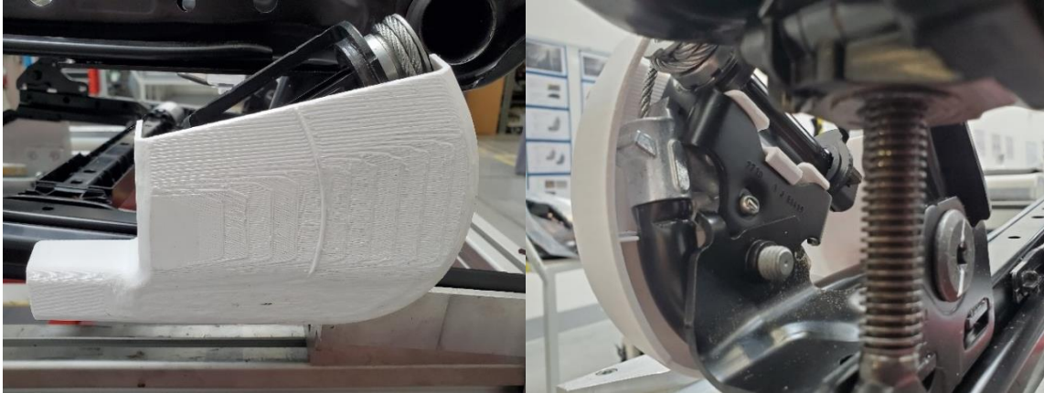
Obrázek 50: Upevněný kryt PLP plastic cover z materiálu PETG
