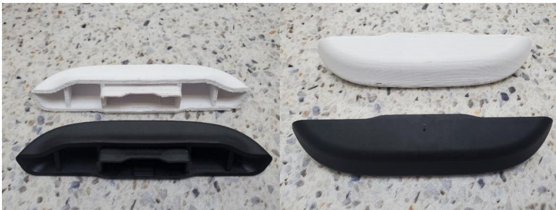
Obrázek 56: Porovnání dolní a horní strany sériového (černě) a vytištěného (bíle) dílu
