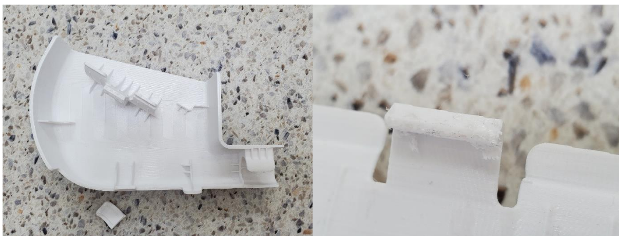
Obrázek 52: Detail poškození krytu z PETG
