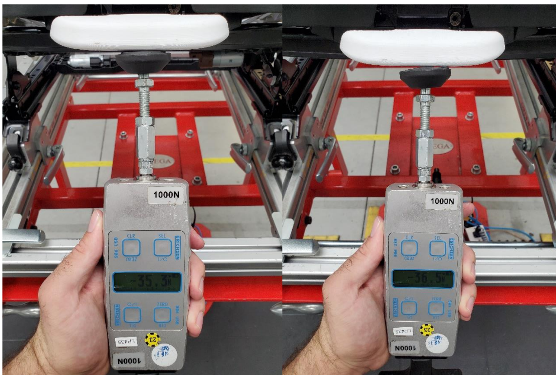
Obrázek 58: Způsob tlačení siloměru pro odjištění mechanismu
