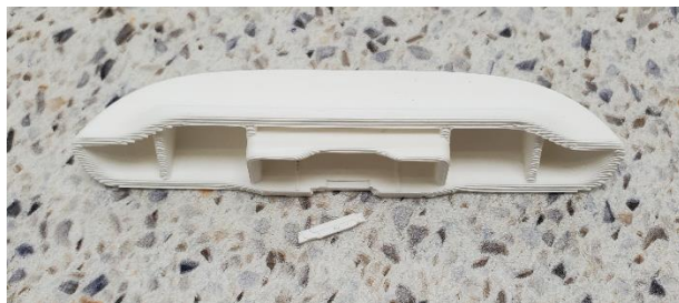
Obrázek 59: Detail poškození vzorku a) z PLA
