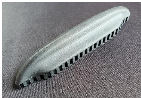
Obrázek 36: Výtisk rukojeti S(C)LA handle z materiálu ABS
