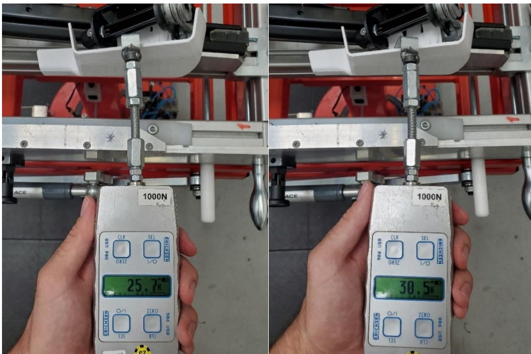
Obrázek 51: Měření max. síly pro uvolnění krytu z PETG
