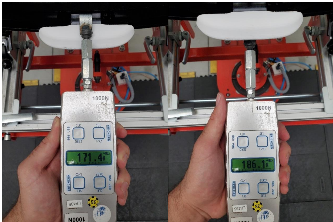
Obrázek 62: Měření max. síly pro uvolnění vzorku rukojeti z PETG
