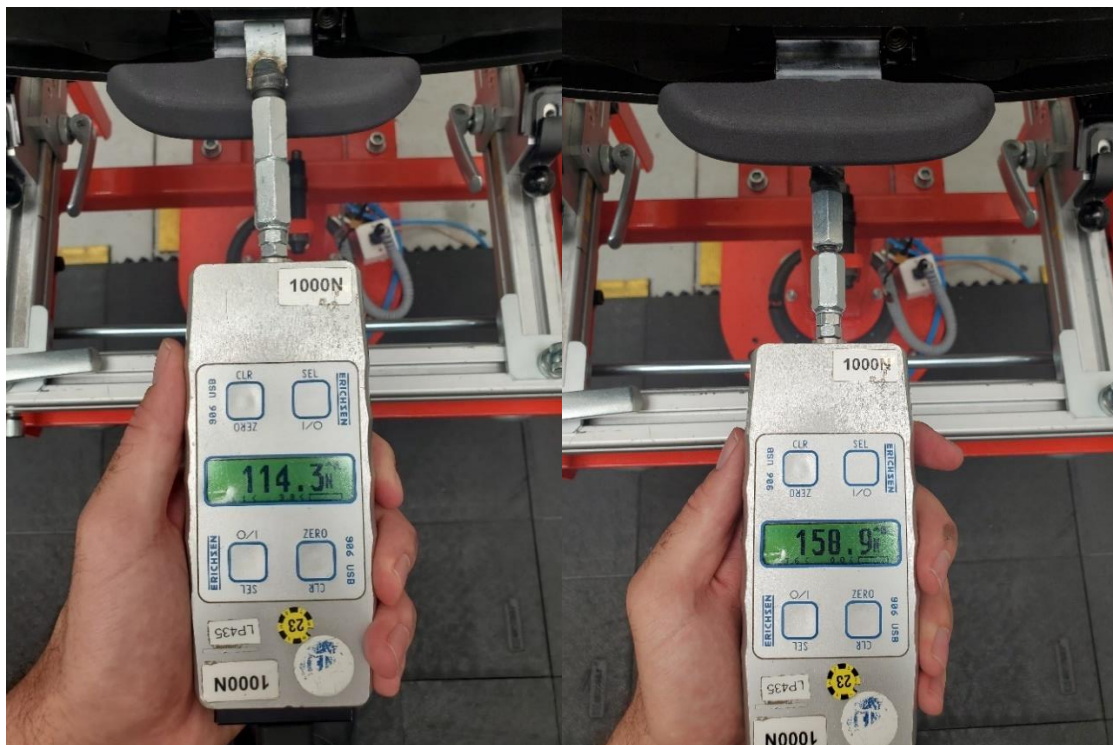
Obrázek 68: Měření max. síly pro uvolnění vzorku rukojeti z PA 12
