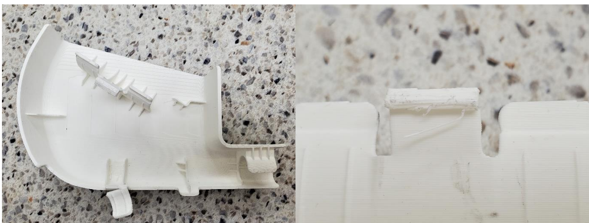
Obrázek 49: Detail poškození krytu z PLA
