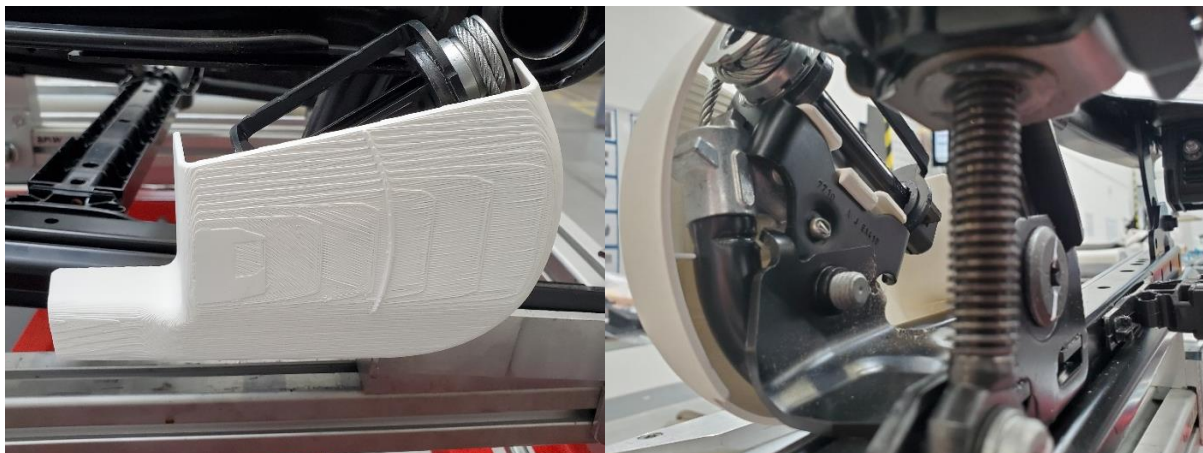
Obrázek 47: Upevněný kryt PLP plastic cover z materiálu PLA
