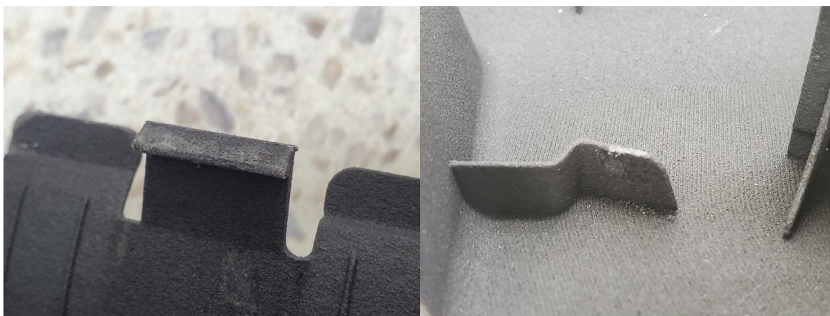
Obrázek 55: Detail poškození krytu z PA 12
