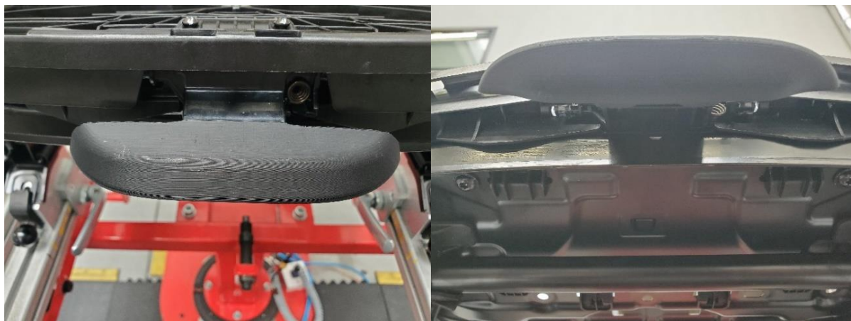
Obrázek 63: Detail uchycení rukojeti z ABS
