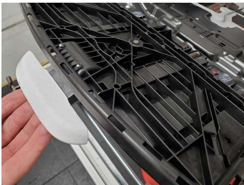
Obrázek 57: Vyzkoušení funkčnosti vytištěné rukojeti (Materiál PETG)
