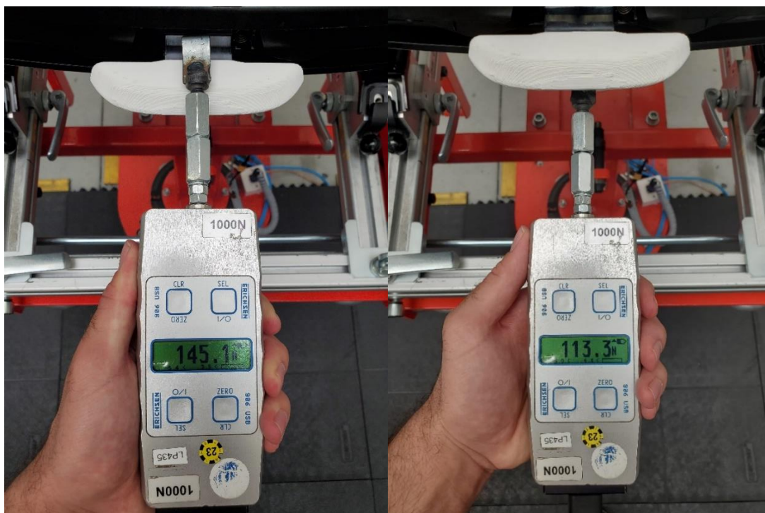
Obrázek 60: Měření max. síly pro uvolnění vzorku rukojeti a) z PLA
