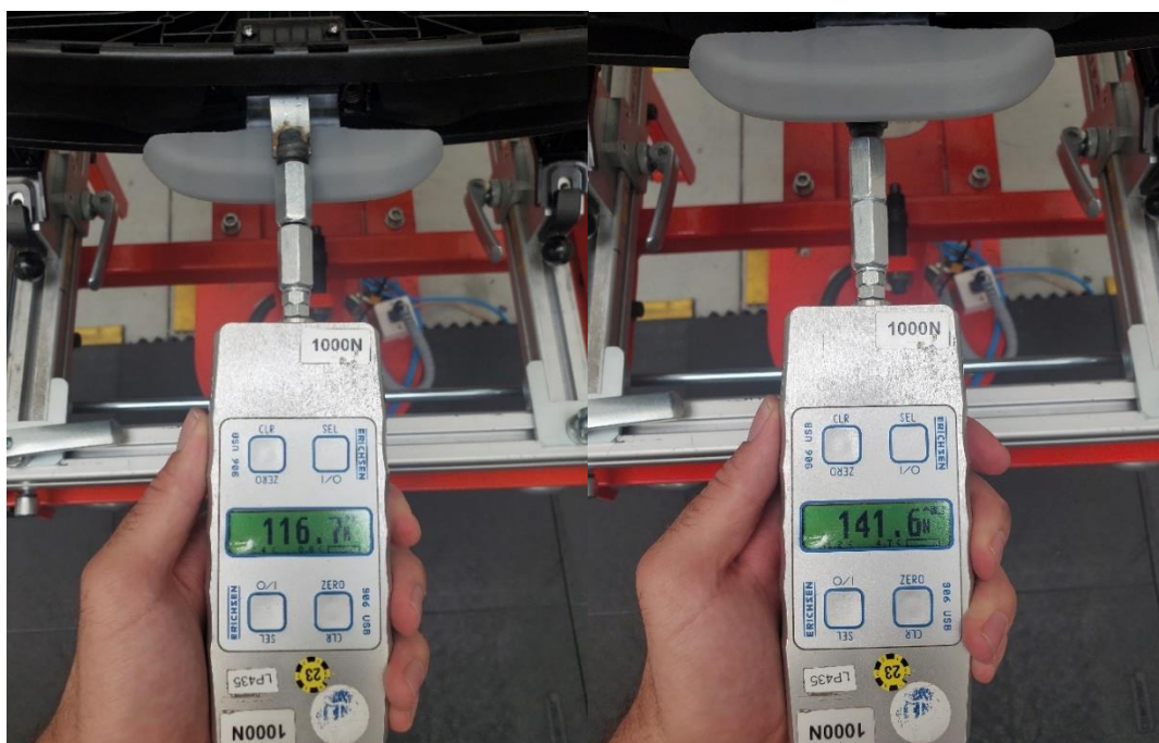
Obrázek 66: Měření max. síly pro uvolnění vzorku rukojeti z Tough 1500 resin
