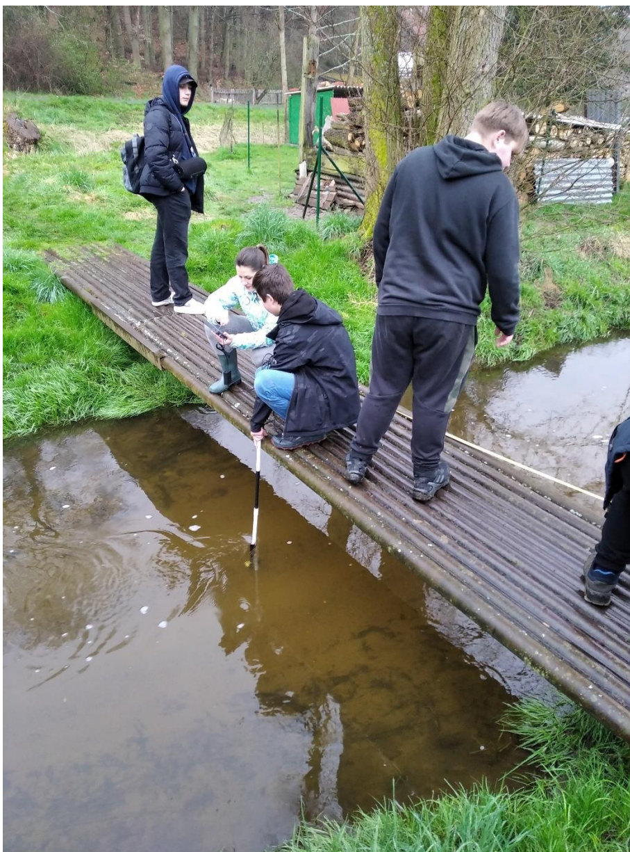
Foto č. 3 – Hydrometrování za pomoci hydrometrické vrtule na potoce Mihovka
