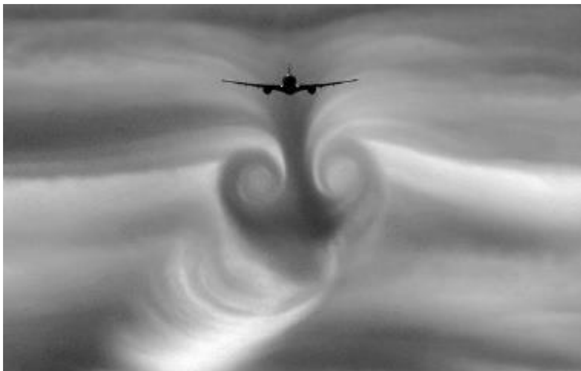
Torbulentní proudění vzduchu za letadlem.
