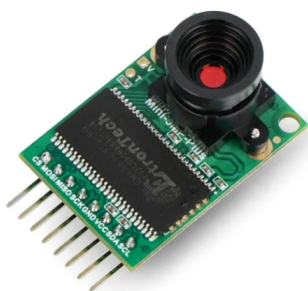
Obrázek 5.3: Kamerový modul ArduCam-Mini OV5642 [2]
