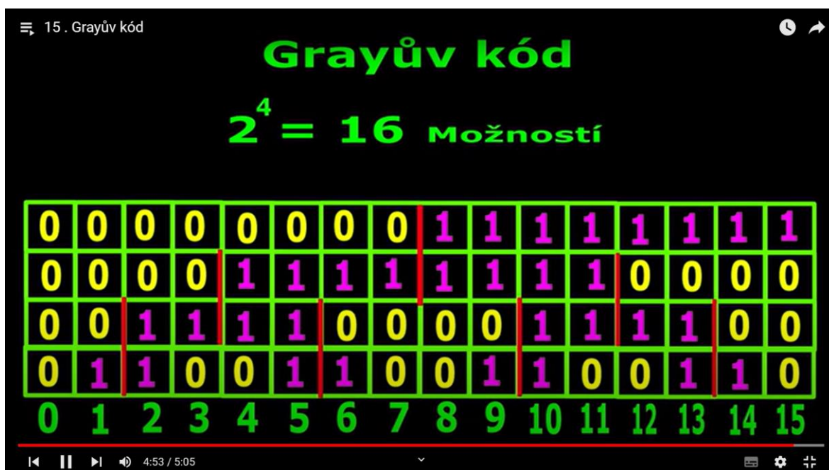
Obrázek 20 - Zobrazení Grayova kódu na 4 bity (Zdroj: Vlastní)
