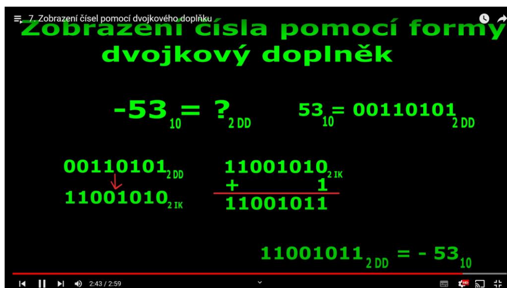
Obrázek 12 - zobrazení čísla -53 z desítkové soustavy ve dvojkovém doplňku (Zdroj: Vlastní)
