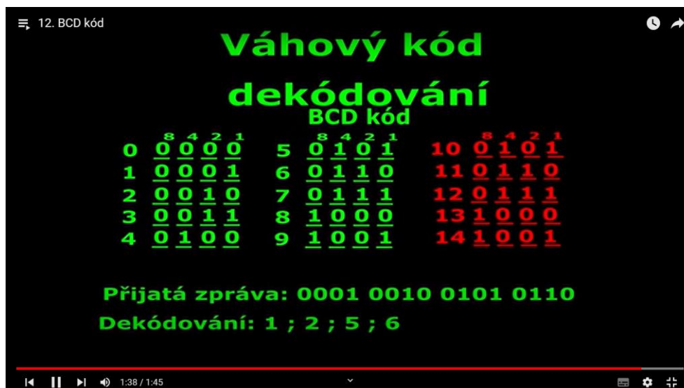
Obrázek 17 - BCD kód s červeně označenou nevyužívanou částí, dekódování zprávy (Zdroj: Vlastní)
