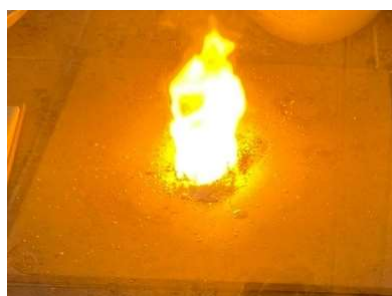
Obrázek 10 Barvení plamene dusičnanem sodným - žlutý plamen
