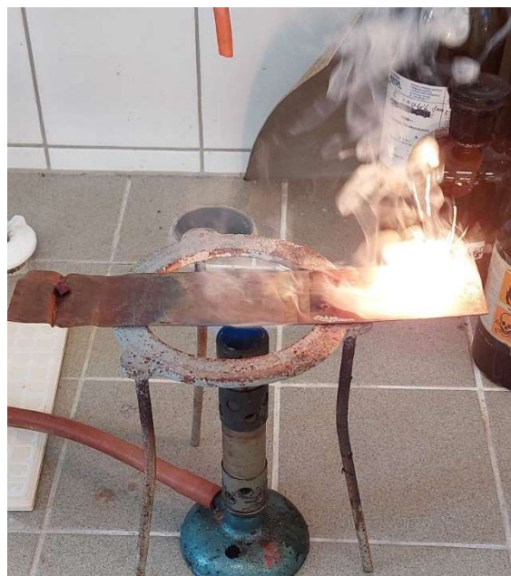
Obrázek 12 Vznícení bílého fosforu
