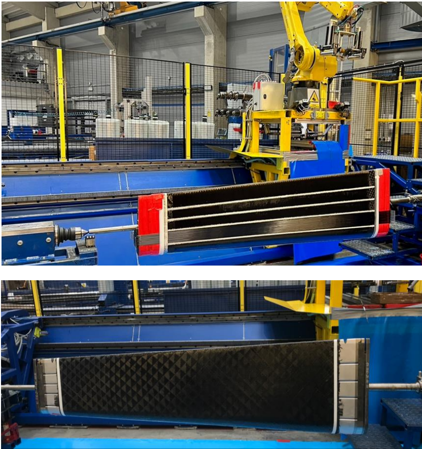
Obr. 11. Navíjecí / kladeč stroj (nahore) a křídélko po navinutí (dole). (zdroj: CompoTech).
