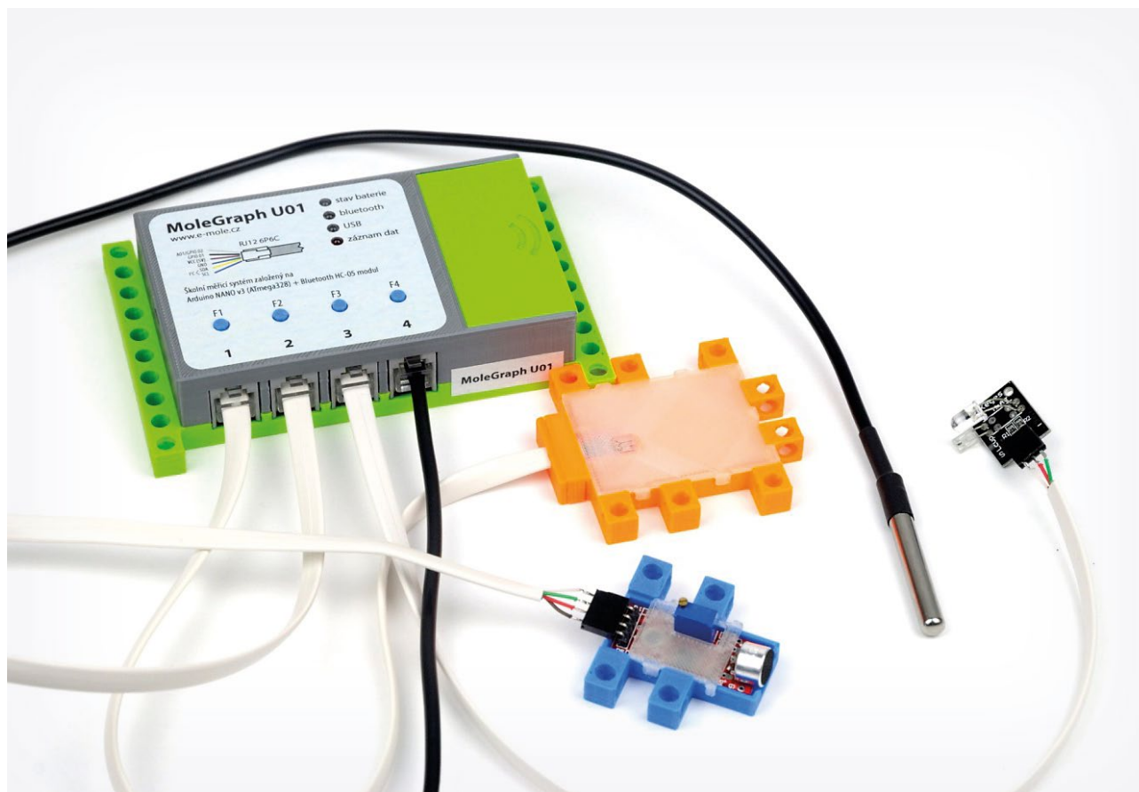
Obr. 2. Školní měřicí systém MoleGraph obsahuje centrální jednotku (zeleno-stříbrná 3D tištěná krabička), ke které je možné připojovat celou škálu čidel, taktéž zakrytovaných v 3D tištěných krabičkách, nebo ponechaných volně (čidlo zcela vpravo).
