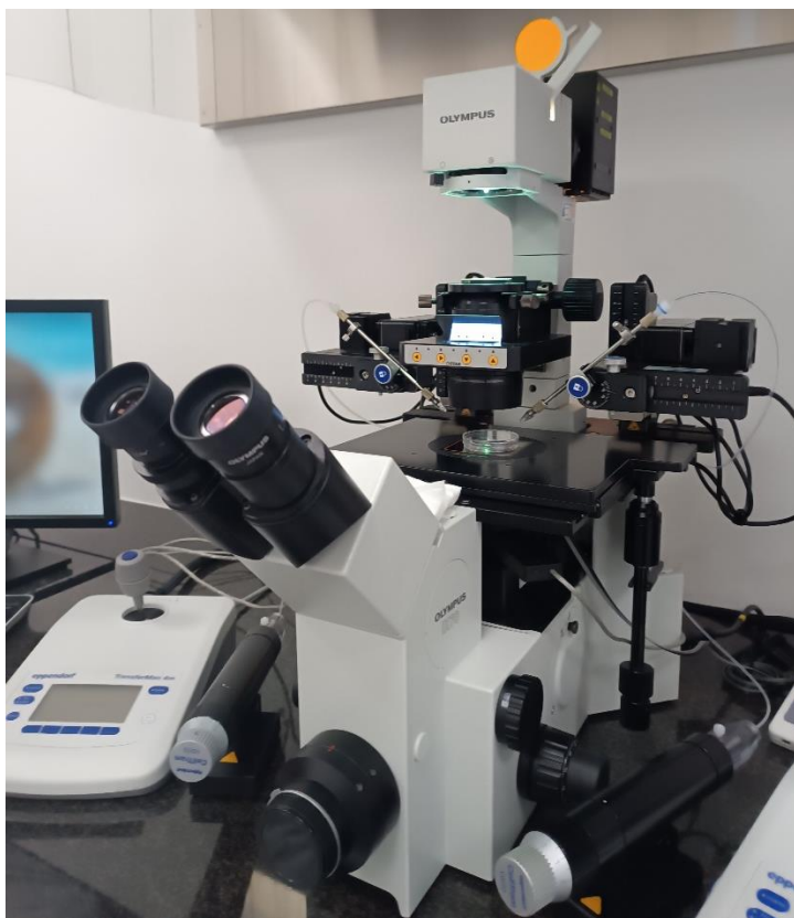
Obrázek 5: Mikroskopická a mikromanipulační jednotka pro IMSI
