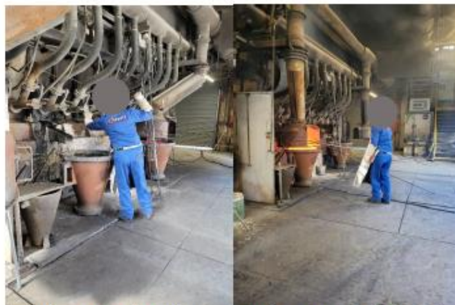
Obrázek 1: Odpich šachtové pece
