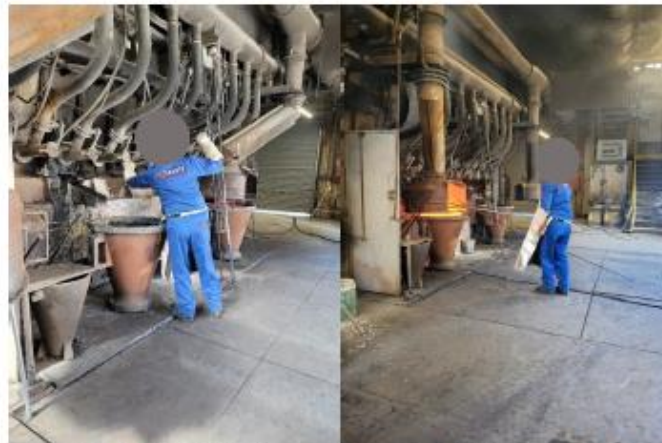
Obrázek 1: Odpich šachtové pece
