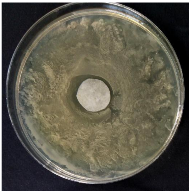
Obr. 13 Diskový difúzní test izolovaného šlechtěného antibiotika bakterie Z1 z agaru na filtračním papíru proti Staphylococcus aureus v pokojové teplotě 18-19°C s inhibiční zónou po 24 hodinách.
