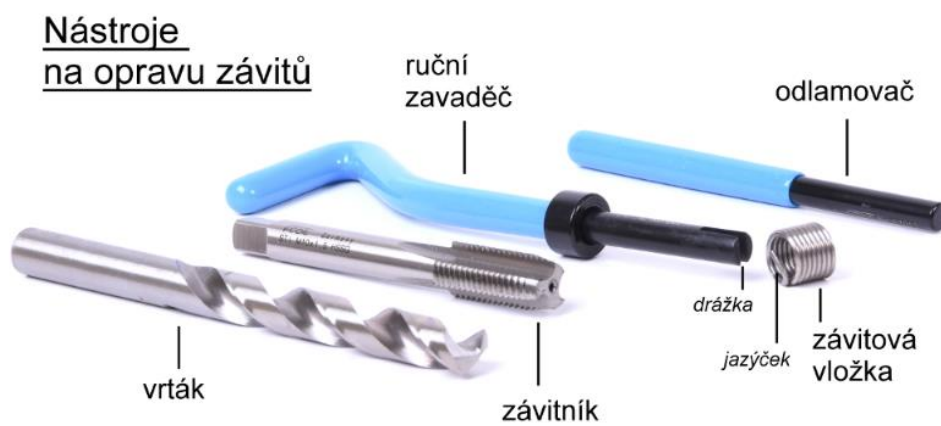
Obr. 13 Nástroje dostupné v sadě pro opravu metrických závitů výrobce V-Coil [25]
