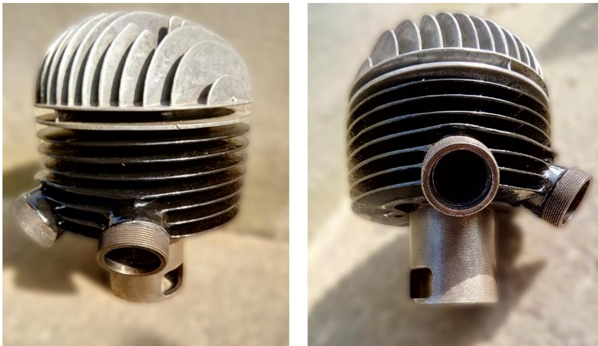
Obr. 18 Sestava hlavy válce a válce motoru JAWA-ČZ 175 typ 356
