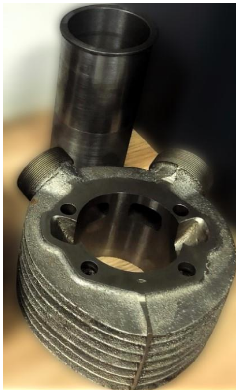
Obr. 16 Připravený válec motocyklu JAWA 250 na opravu novou vložkou od úpravce Pavla Hozmana [26]
