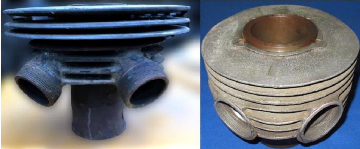
Obr. 17 Porovnání obalu válce později uživatelsky upraveného jinak sériového motoru typu 356 z litiny [27] s továrním soutěžním obalem válce motoru JAWA 250 typ S553 z hliníkové slitiny [28]
