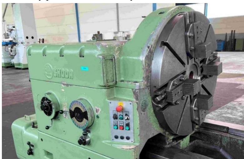
Obr. 6 Lící deska na soustruhu ŠKODA SRM 1000 [19]
