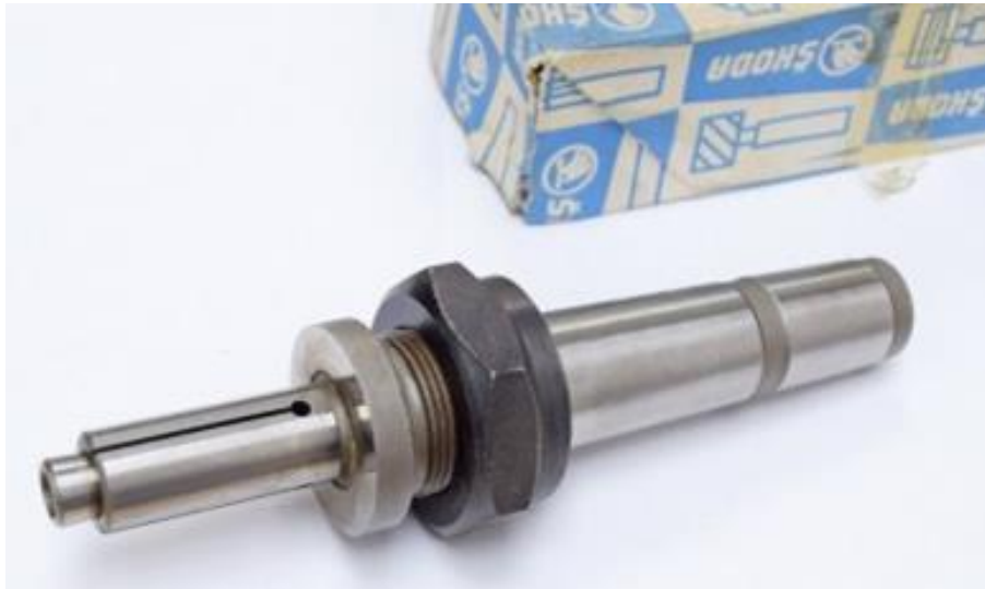
Obr. 5 Rozpínací trn ŠKODA s maticí pro demontáž přípravku z vřetena stroje [18]
