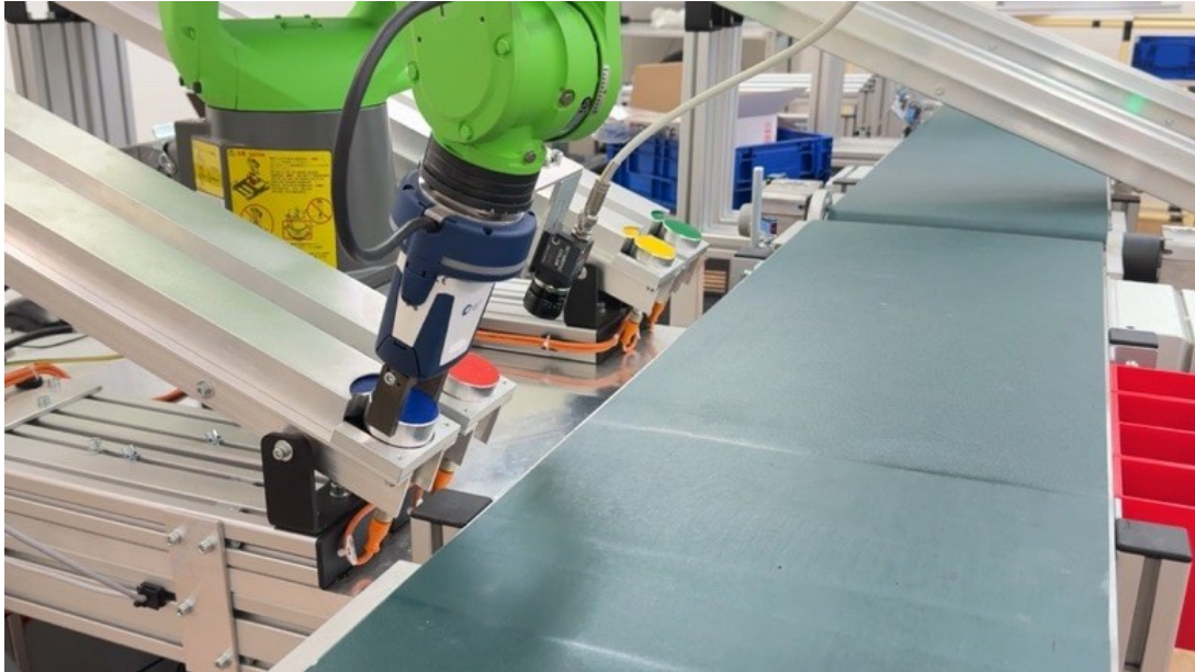
Obrázek 4-29 - Pozice po uchopení puku
