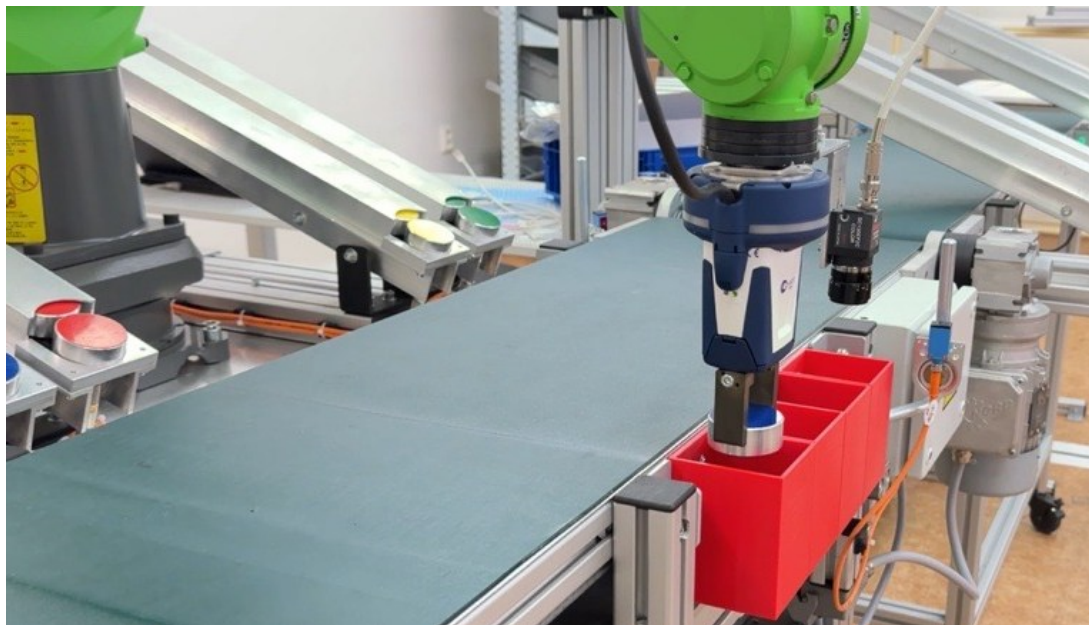
Obrázek 4-30 - Pozice pro uvolnění puku
