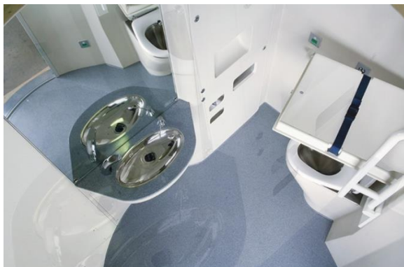
Obrázek 6 - detail z horní části integrované kabiny toalety vlaku TALENT 2 [5]
