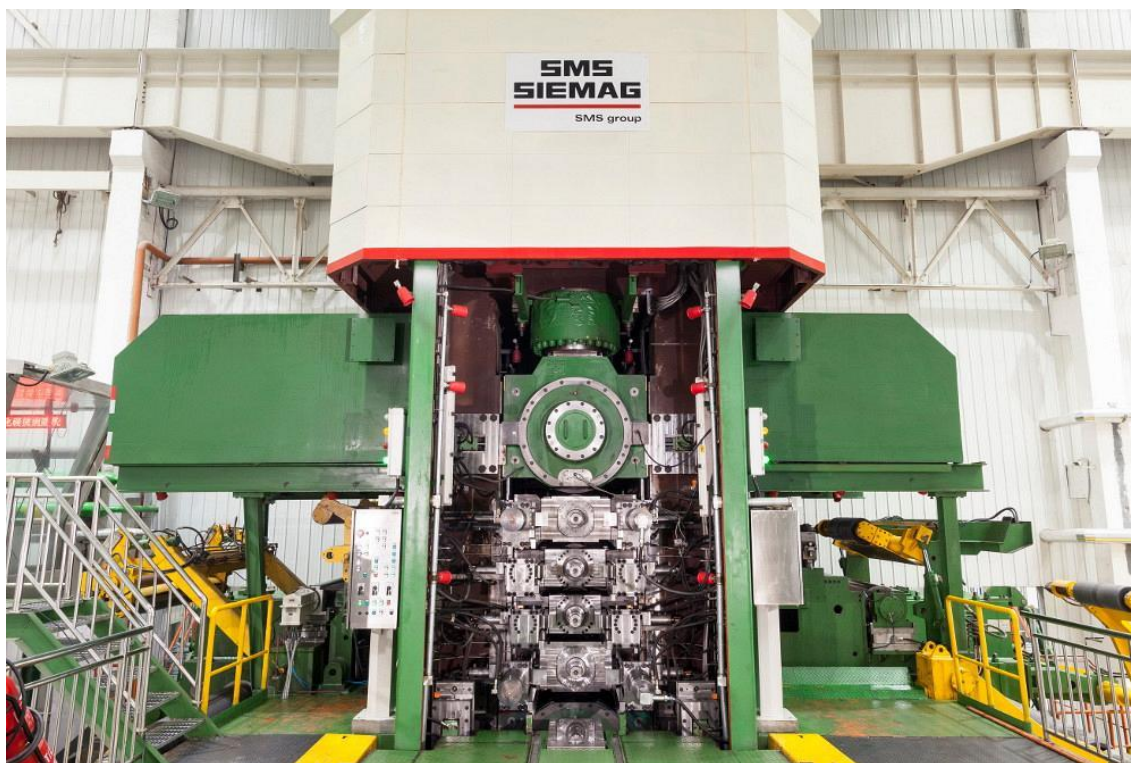
Obr. 2- 6 Válcovací stolice pro válcování hliníku za studena od firmy SMS group [14]
