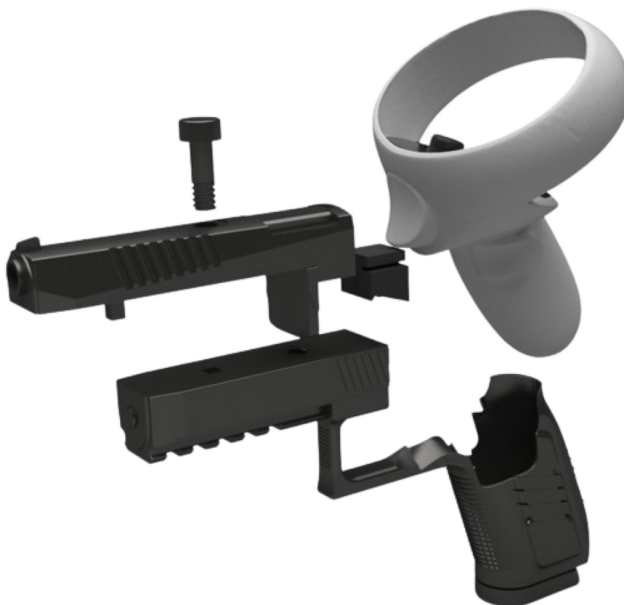
Obr. 48 Finální nástavec v rozstřelu ve tvaru zbraně CZ P09
