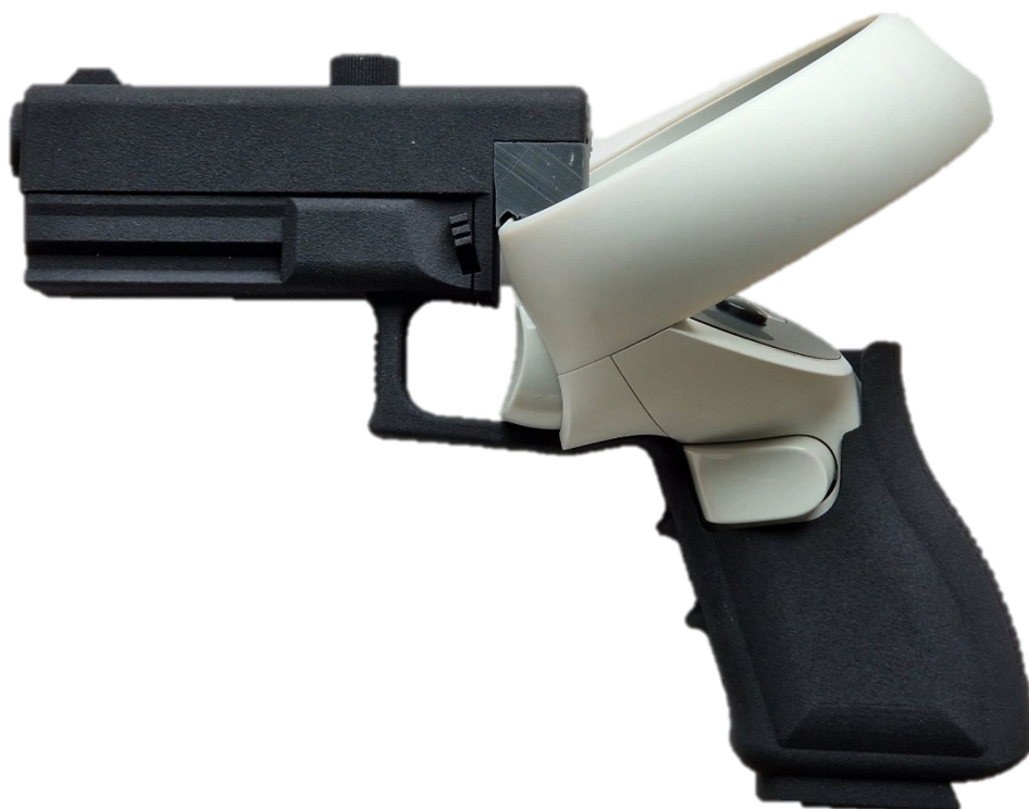
Obr. 49 Kompletně vytištěný nástavec ve tvaru zbraně Glock 17
