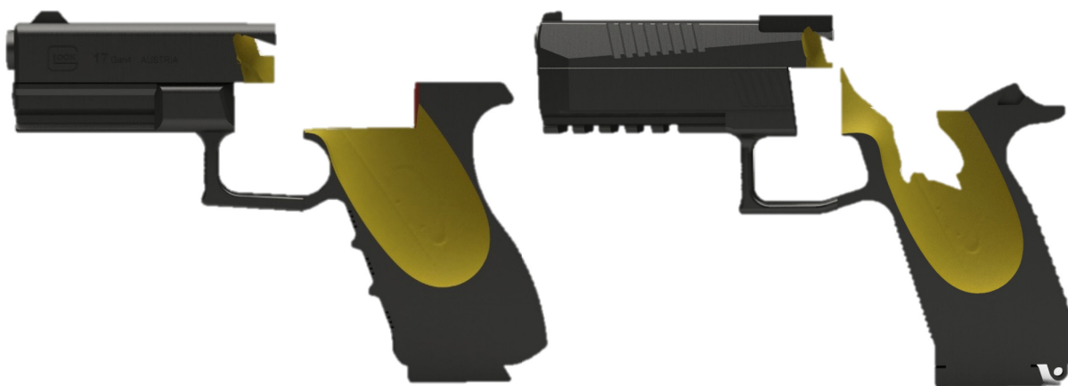
Obr. 38 Varianta nástavců s ovladačem co možná nejnižší (Glock 17 vlevo a CZ P09 vpravo)
