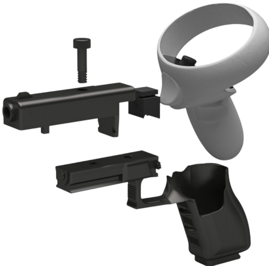
Obr. 46 Finální nástavec v rozstřelu ve tvaru zbraně Glock 17
