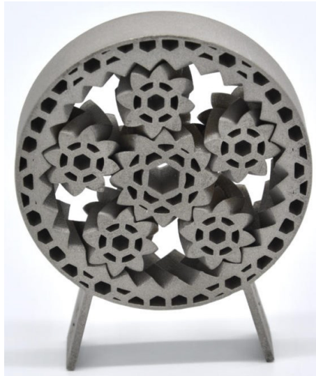
Obr. 25 Tvarově složitý díl vytisklý z oceli technologií DMLS [44]
