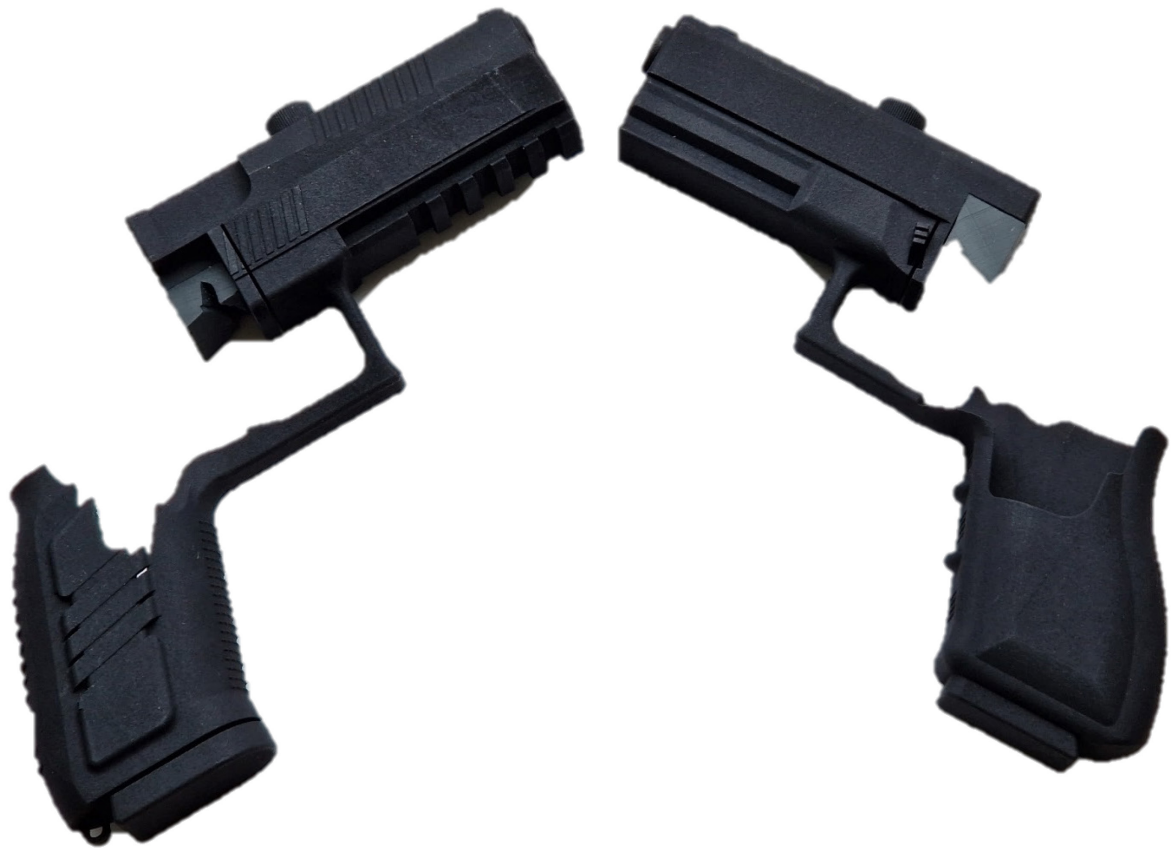
Obr. 51 Oba vytištěné nástavce pohromadě
