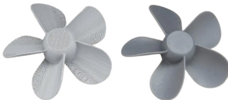
Obr. 23 Lodní šroub vytisklý technologiemi FDM (vlevo) a SLA (vpravo) [42]
