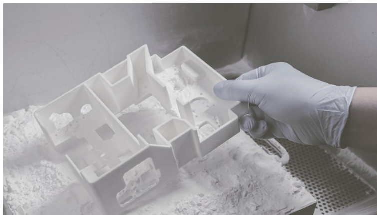
Obr. 24 Vytisklý model domu s přebytečným práškem [43]
