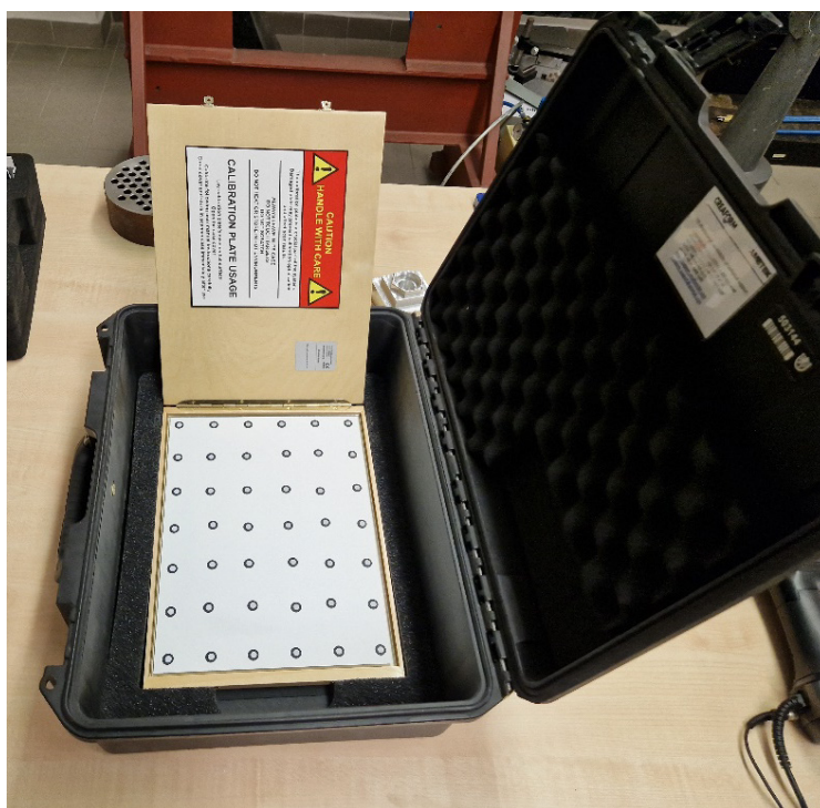
Obr. 31 Kalibrační deska pro ruční skener
