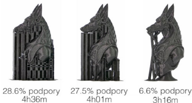
Obr. 22 Různé typy a nastavení podpory a jejich vliv na spotřebu materiálu a čas tisku [41]
