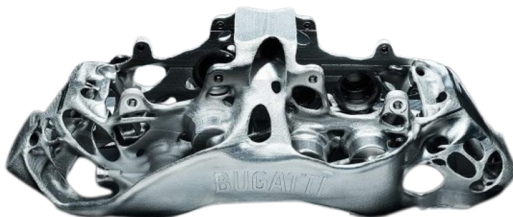
Obr. 18 Vytisknutý brzdový třmen z Bugatti Chiron [32]
