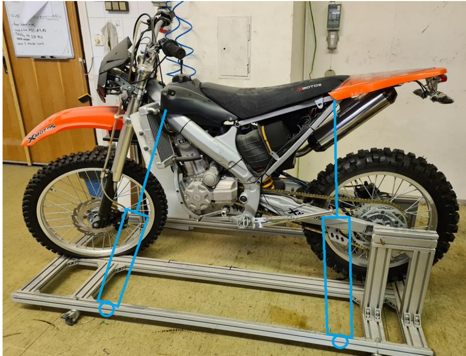
Obrázek 24 Rozmístění pohonů na použitém motocyklu
