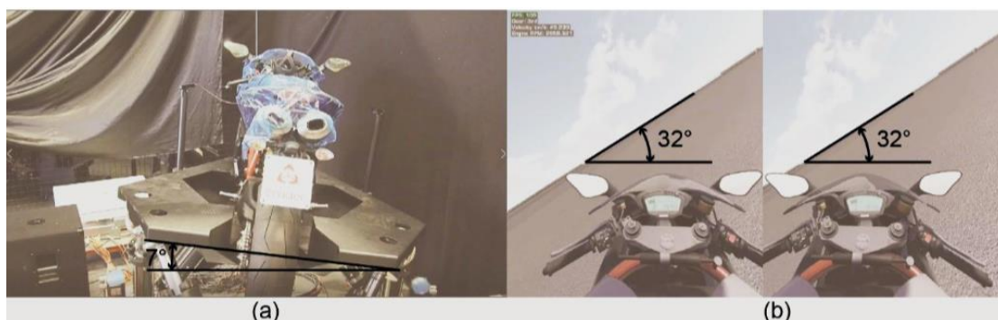
Obrázek 11 Naklápění plošiny a vizualizace obrazu [7]
