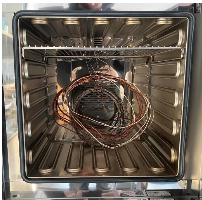
Obr. 16: Izolační materiály v horkovzdušné peci při tepelném zrychleném stárnutí
