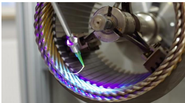
Obr. 2 Impregnace pomocí techniky zakapávání (převzato z [12])
