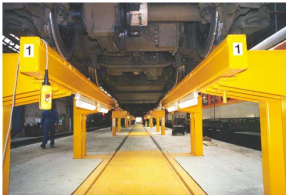
Obrázek 17 – Podzemní výtah Kumbruch GmbH [14]
