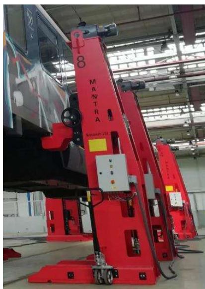
Obrázek 11 – Patkový zvedák s horizontálně přestaveným nosným ramenem [11]
