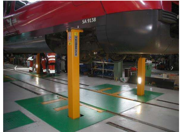
Obrázek 16 – Podzemní výtah Kumbruch GmbH [14]
